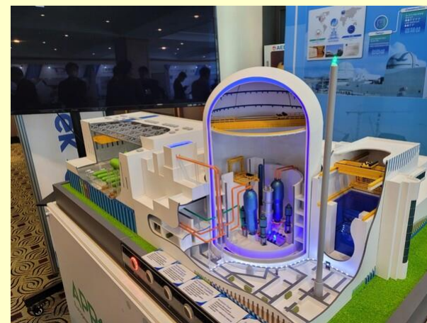
Schéma bloku APR1000
